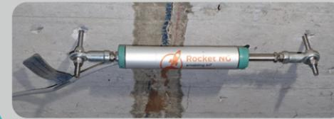
Einfache und sichere Montage für Rissbreitenmessung bei Brücken, Stützmauern, Gebäuden und Felsformationen.
